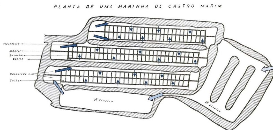
Exemplo de uma salina tradicional de Castro Marim (neste caso com dois viveiros e três marinhas, cada uma com duas pernas (fonte: Ferreira da Silva, 1959)
