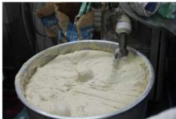
Figura 2. Processo de amassadura mecânico - recurso a uma batedeira elétrica
